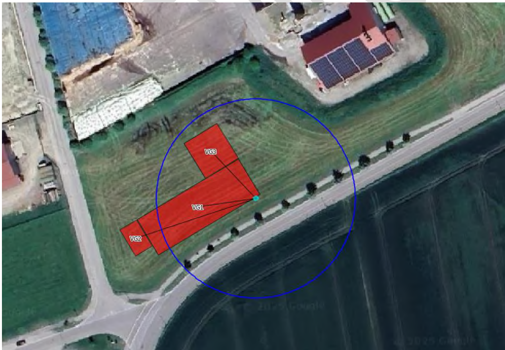
Abbildung 10: Einwirkungsbereich der Abgasableiteinrichtung nach VDI 3781 Blatt 4 für die Trocknungsanlage
