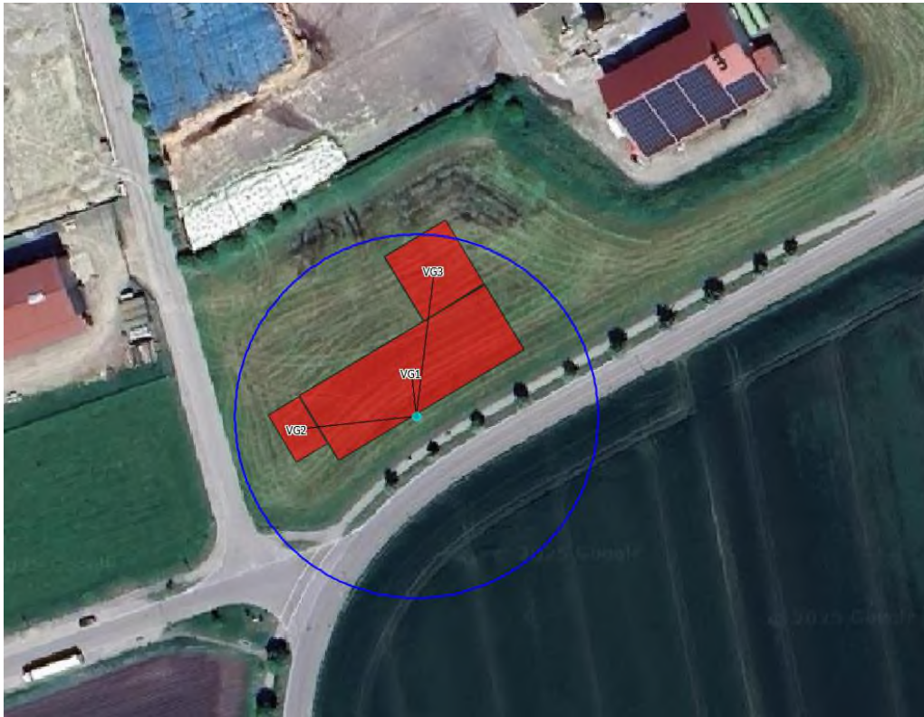
Abbildung 9: Einwirkungsbereich der Abgasableiteinrichtung nach VDI 3781 Blatt 4 für die Pyrolyseanlage
