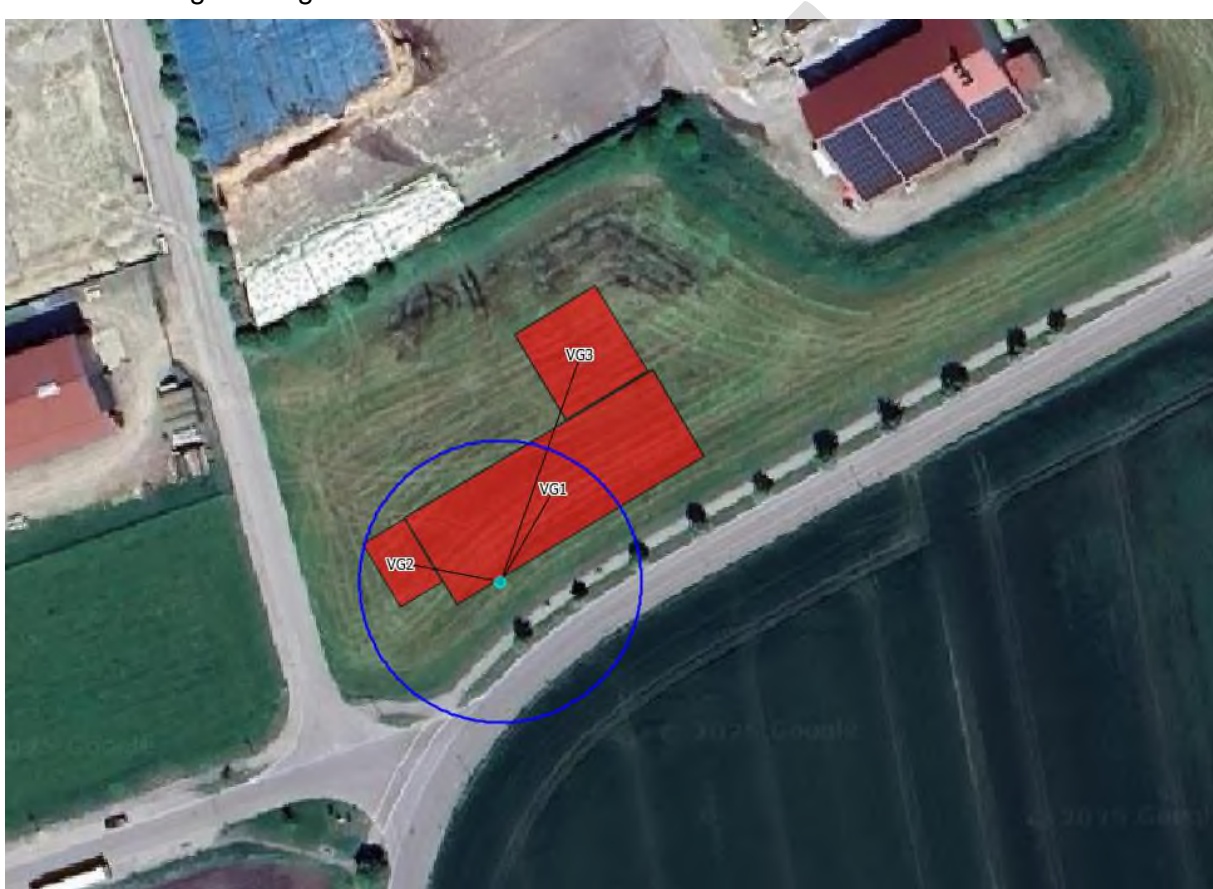
Abbildung 8: Einwirkbereich der Abgasableitinrichtung nach VDI 3781 Blatt 4 für die Feuerungsanlage
